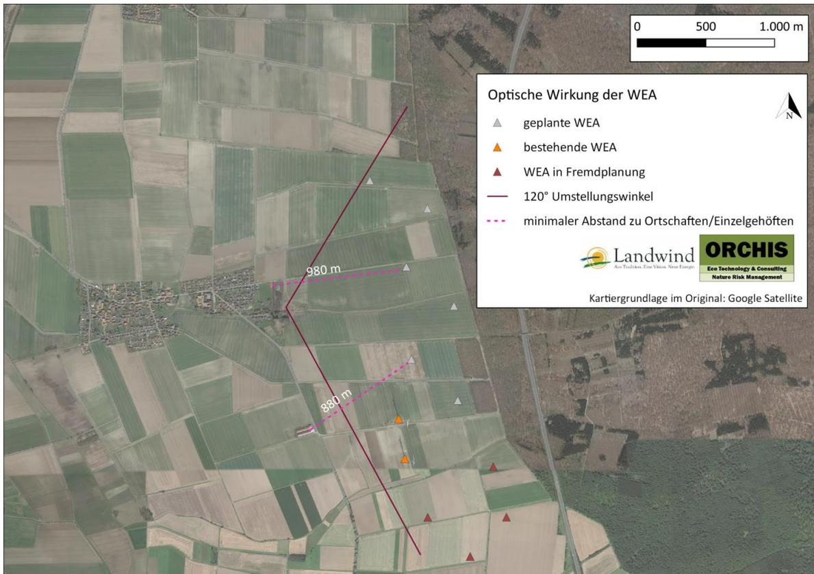
Abbildung 11: Die geplanten und die bereits im Gebiet bestehenden WEA im Zusammenhang mit der nächsten umgebenden Siedlung und Einzelgehöften. Dargestellt sind der minimale Abstand zu den zu den WEA am nächsten gelegenen Gebäuden sowie der maximal akzeptable Umstellungswinkel. Kartengrundlage: Google Satellit.
