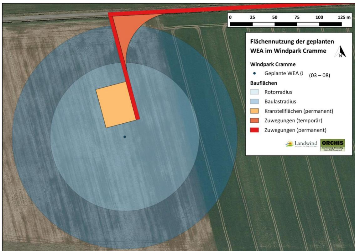
Abbildung 3: Schema der Flächennutzung am Beispiel der Anlage WEA 07.
